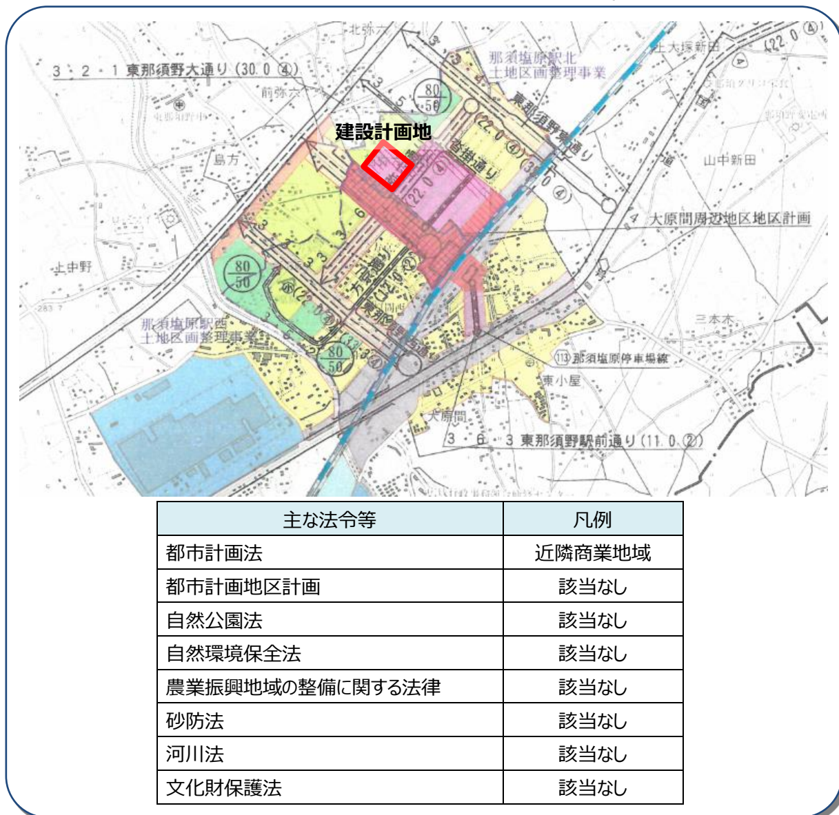
図表 4-1 建設計画地周辺の法規制状況（資料：那須塩原都市計画図）
