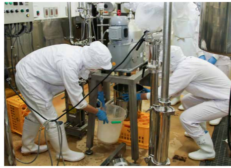
①新鮮な拓陽生乳を遠心分離させ、脱脂乳を作る
