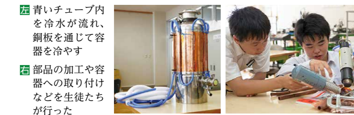
青いチューブ内を冷水が流れ、銅板を通じて容器を冷やす 部品の加工や容器への取り付けなどを生徒たちが行った
