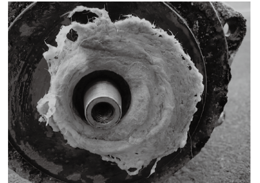
↑ 布類や水に溶けない紙などが巻き付いたポンプの吸込口 → 意外と知らないマンホールの内部
