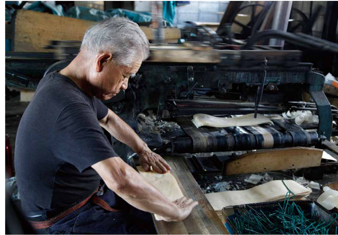
職人の作業風景。0.15~0.18mmの製品規格の厚みに削り出すまで10年かかるという熟練の技
