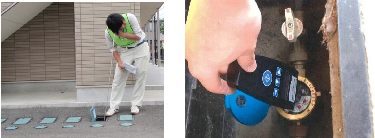
図 5.15 漏水調査の実施状況（左：個別音聴、右：時間積分式）
