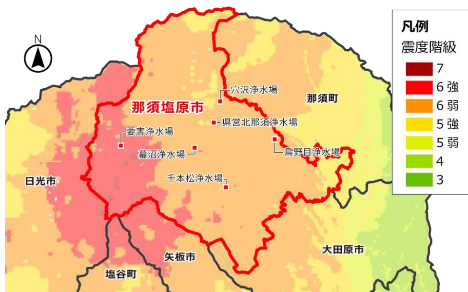
図 3.2 関谷断層地震時の震度分布図（参照元：栃木県地震被害想定調査報告書）
