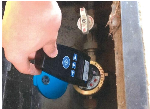
図 5.15 漏水調査の実施状況（左：個別音聴、右：時間積分式）
