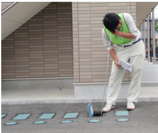
図 5.15 漏水調査の実施状況（左：個別音聴、右：時間積分式）
