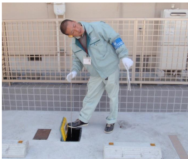
図 5.11 漏水調査の実施状況
