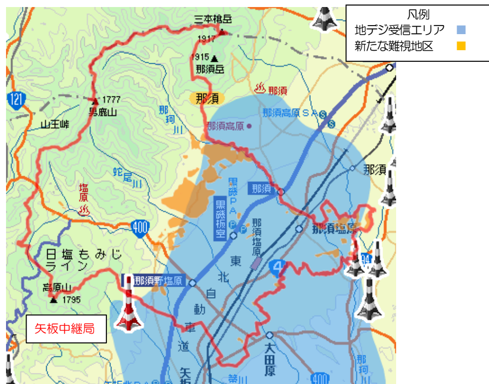
矢板中継局地上デジタルテレビ放送エリアと新たな難視聴地区
