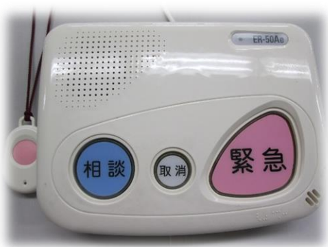
緊急通報装置
