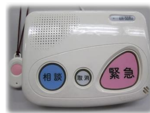
【緊急通報装置】
