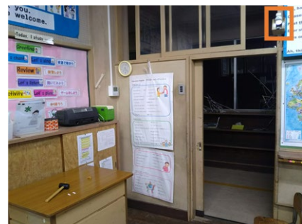
図2 照度測定キットの設置位置 (右上のオレンジ枠)
