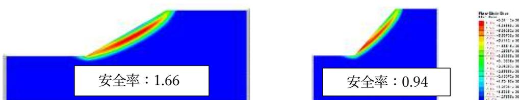
図 3-2-2(2) 板室地区 解析結果例 地下水位=地表面（左：勾配 30 度、右：勾配 50 度）
