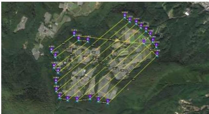
図 2-3-6-2(1) ドローンの飛行計画（Litchi 2.9.1 を用いて作成）
