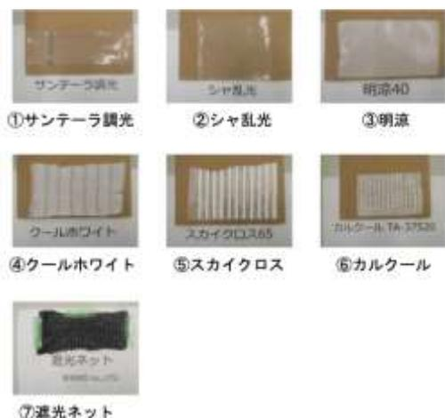
図 2-3-3-1(2) 供試遮光シートの外観
