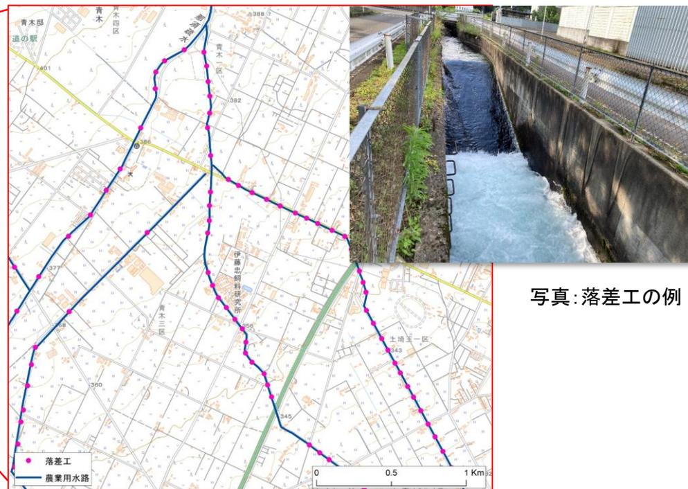
写真：落差工の例
