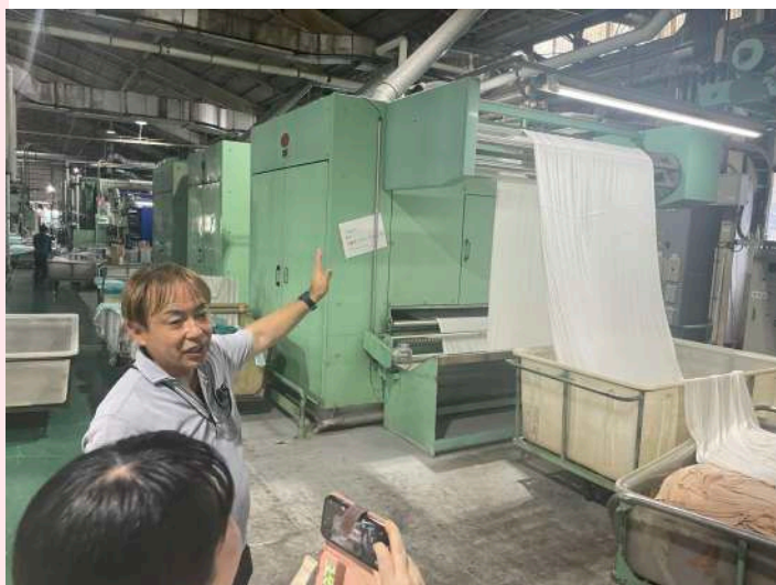
染色した生地を乾燥させる設備
