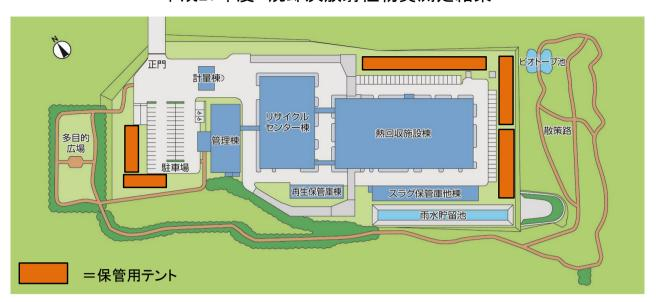
※下表の「処分方法」で「一時保管」となった焼却灰は上に示す保管用テントで保管しています。
