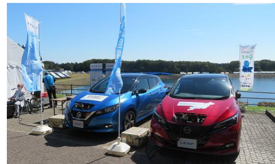
▼競技会場で使用する電力を市内の小水力発電で充電した電気自動車から供給
